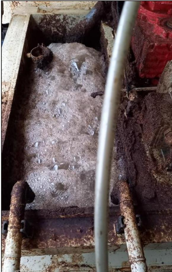
**Bild B.23 Starke Schaumbildung im Nitritationsreaktor. Verkrustungen durch mit dem Schaum ausgetragenen Feststoffen sind gut zu erkennen**
