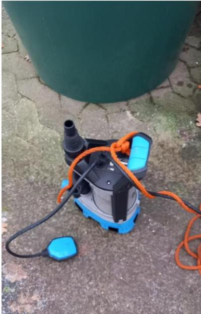
**Bild B.14 Tauchpumpe zum Befüllen der Vorlage**
