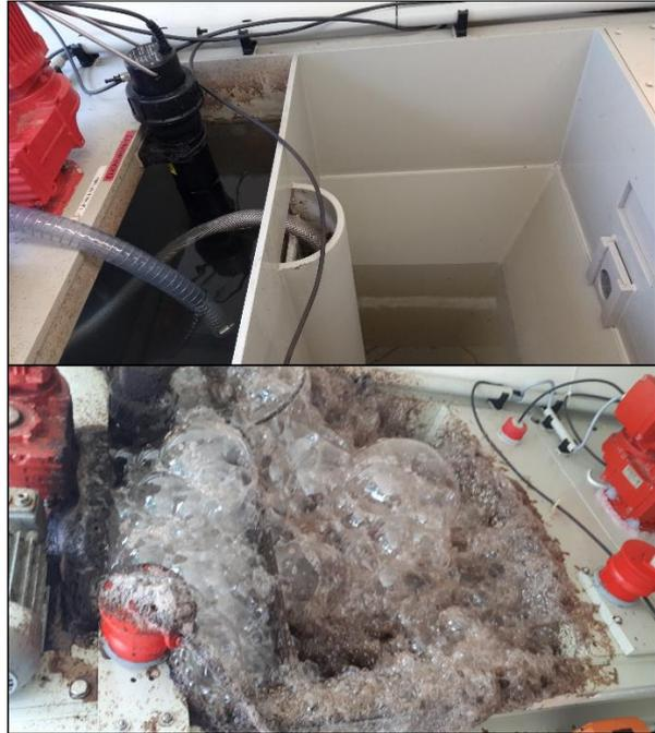
**Bild B.24 Übersäumen des Nachklärbeckens der Nitritation (unten) und der mit Leitungswasser gefüllte Reaktor (oben) zum Vergleich**
